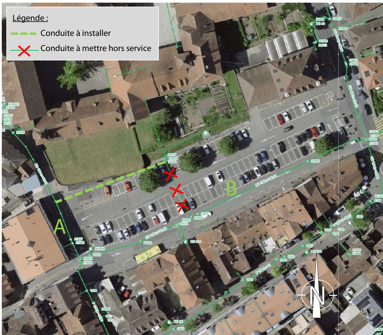
Remplacement de la conduite d'eau à la Place de la Concorde
